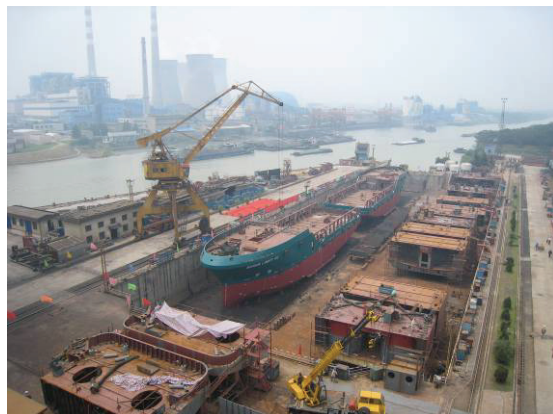
Deux coques en construction et plusieurs modules standardisés en préparation pour d'autres navires
