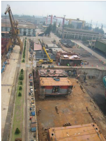
Deux coques en construction et plusieurs modules standardisés en préparation pour d'autres navires
